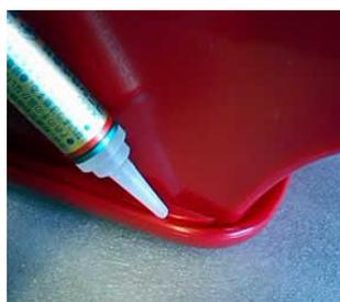
写真のネジ締め部分が破損している場合には、また鍵盤が外れてしまう恐れが大きいため、組立後下図のように瞬間接着剤またはプラスチック用接着剤などで接着してしまうことをお勧めします。(ただしこの場合にはそれ以後の補修はできなくなってしまいます。)
