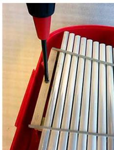
さらに分解する場合は音源のねじを緩めて音源を取り外すと鍵盤も取り外すことができます。
