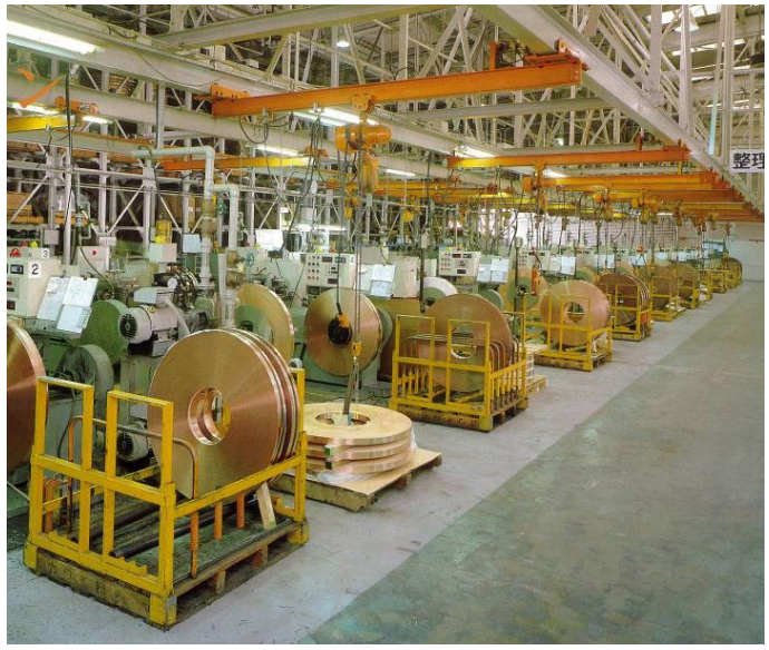
異形圧延 Vミル工程
